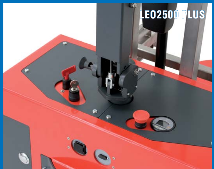
LEO2500 PLUS mit Schlüsselschalter, Not-Aus-Taster, zusätzlichem Trennschalter und Anzeige für Batterieladezustand
